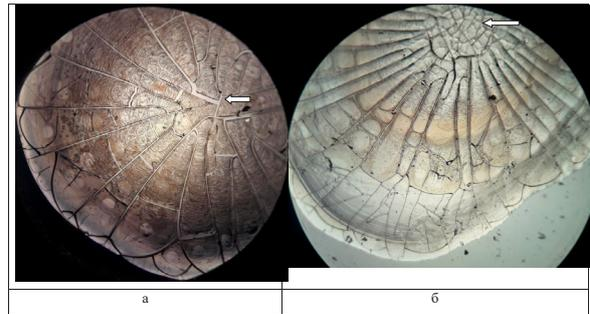
Рис. 1. а) ФСК с сохранённой центральной зоной; б) ФСК с разрушенной центральной зоной. Ув.х40.
