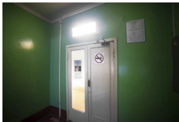
Рис. 3. Высокое размещение (более двух метров) настенной навигационной таблички на этажной лестничной площадке, Свердловская область
