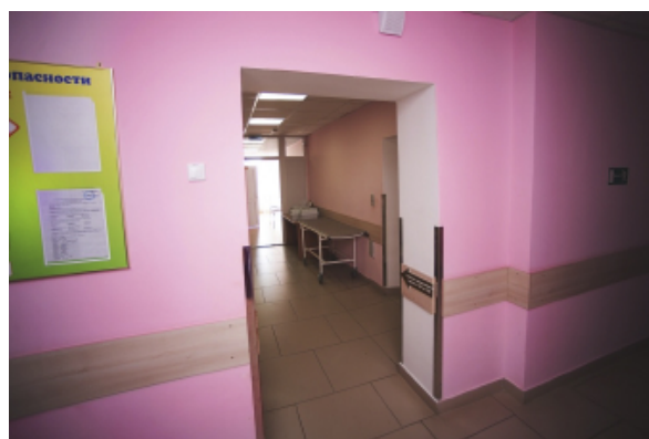
Рис. 4. Низкое размещение (менее одного метра) коридорной настенной навигационной таблички, Красноярский край
